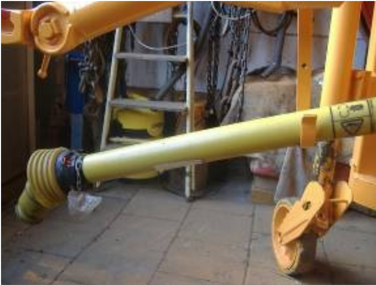
Foto: Houd de koppeling van de aftakas schoon
