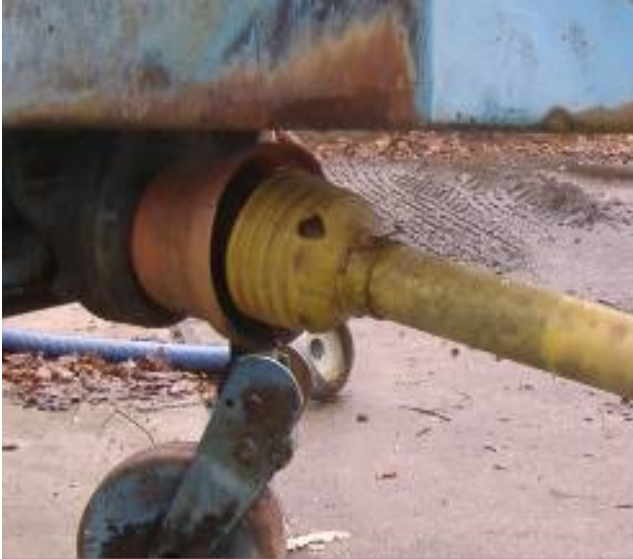
Kap werktuigzijde aanwezig
