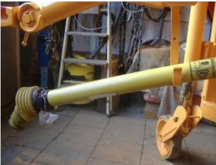
Foto: Houd de koppeling van de aftakas schoon
