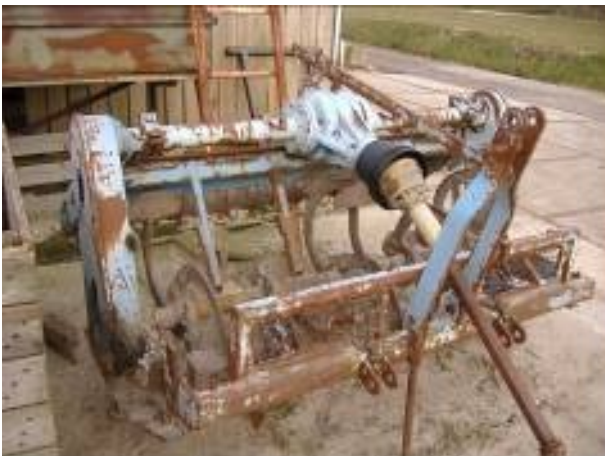
Foto: Oude onbeveiligde spitmachine
