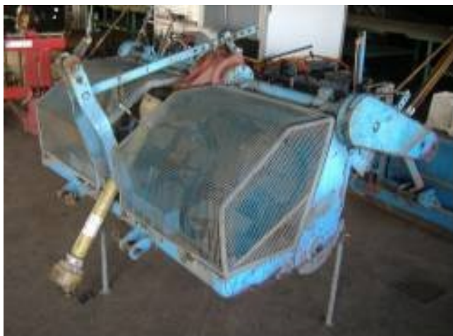
Foto: Oude beveiligde spitmachine
