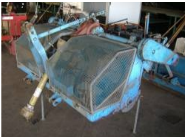
Foto: Oude beveiligde spitmachine
