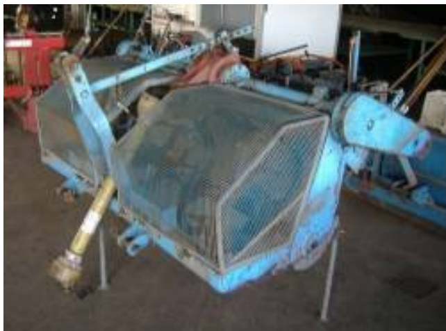
Foto: Oude beveiligde spitmachine
