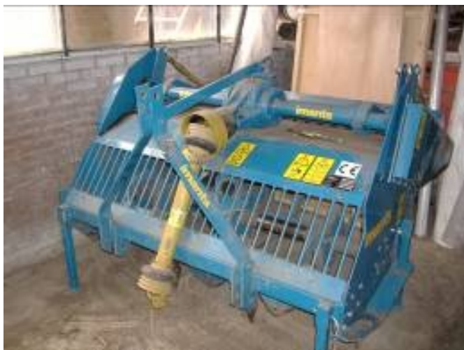
Foto: Moderne beveiligde spitmachine (CE)
