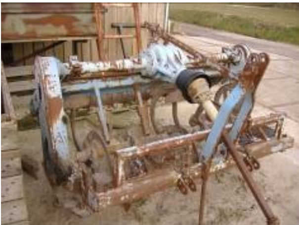
Foto: Oude onbeveiligde spitmachine
