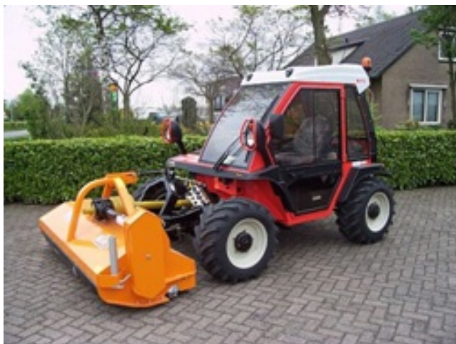
Foto: Trekker met laag zwaartepunt
