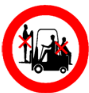
Afbeelding: Verbodsbord meerdere personen op heftruck
