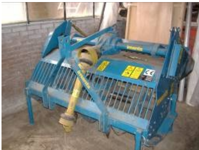
Foto: Moderne beveiligde spitmachine (CE)
