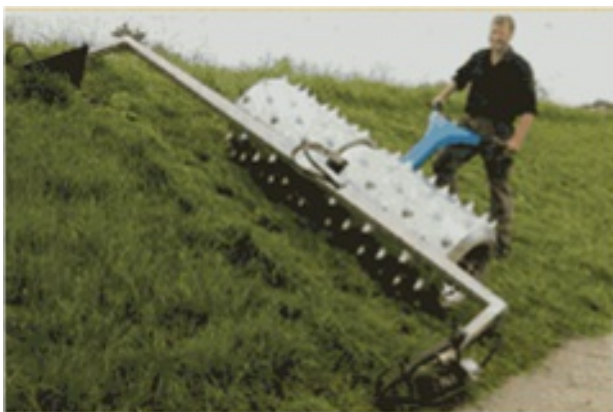
Tweewielige trekker met speciale noppen voor taluds
