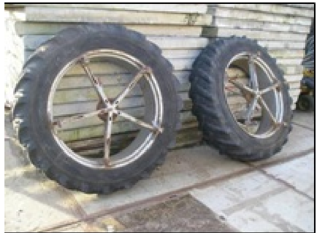
Wielen fout (losstaand) opgeslagen
