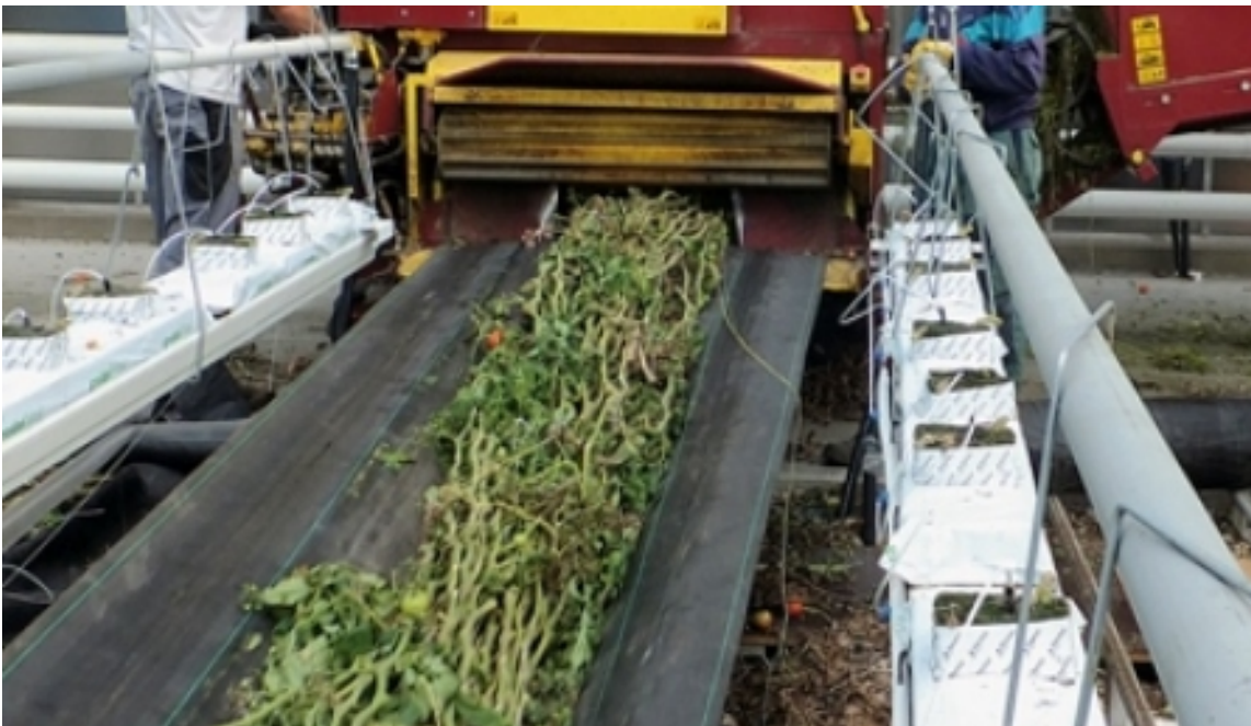
Onvoldoende afgeschermdde machine
