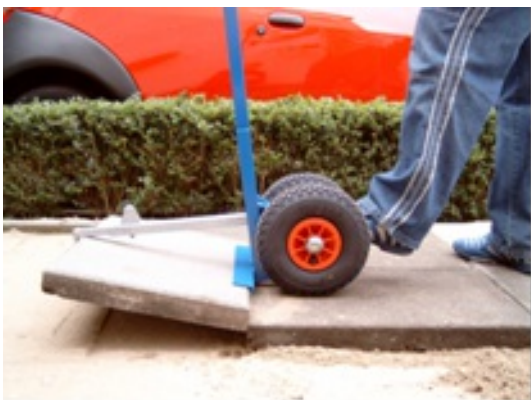
Voorbeeld van eenvoudige klem voor tegels (zoals 60 x 40 of 50 x 50)
