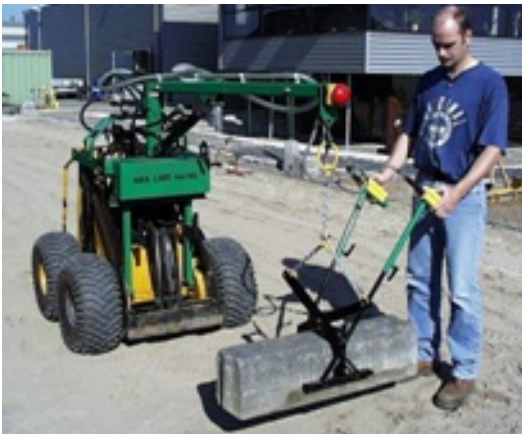
Foto: Mechanische bandenklem
