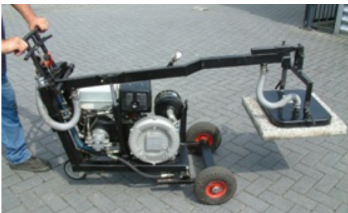
Voorbeeld van vacuÛmtiller voor grotere tegels
