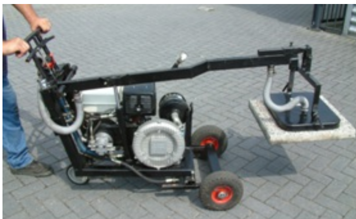
Voorbeeld van vacuümtiller voor grotere tegels
