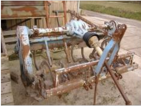
Foto: Oude onbeveiligde spitmachine
