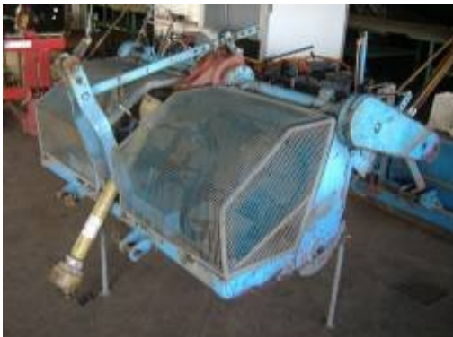
Foto: Oude beveiligde spitmachine
